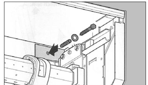
Die Abbildungen zeigen den generellen Montageablauf von Rolltoren. Abgebildet ist hier die Montage eines Rolltores mit einem 360mm-Kasten und Anrollkonsole. Auf der motorabge-
