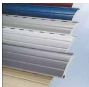
ALU-Panzer, doppelwandig, ausgeschäumt, abriebfest und witterungsbeständig, dickschichtlackiert
